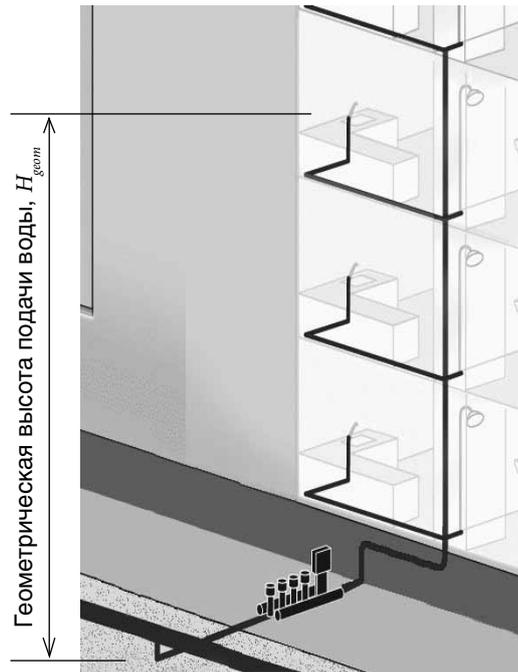
$\Sigma H_{tot,l}$  – сумма потерь напора в трубопроводах системы водоснабжения по длине, с учетом местных сопротивлений.
